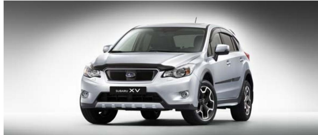
Представлен автомобиль с дефлектором капота, решеткой радиатора (ячеистого типа), передним нижним кожухом (пластик), солнцезащитными козырьками дверей, боковой защитой, боковым нижним кожухом (пластик), брызговиками и спойлером крыши.
