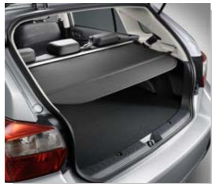
Выдвижная шторка багажного отсека
