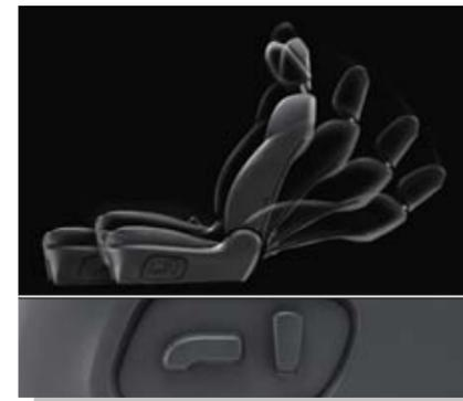
Сиденье водителя с электроприводом регулировки положения в восьми направлениях (модель 2.0i Premium)
