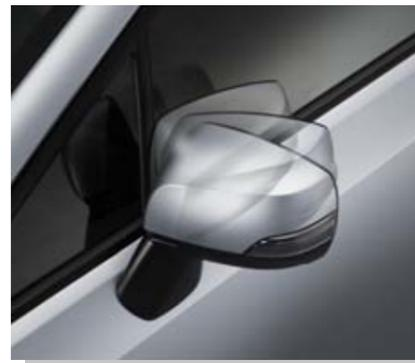
Боковые зеркала с электроприводом складывания (модель 2.0i Premium)
