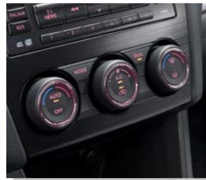
Двухзонная автоматическая система кондиционирования воздуха (модель 2.0i Premium)
