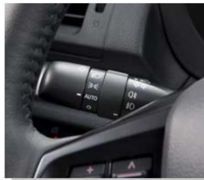
Автоматическая функция включения/выключения фар (модель 2.0i Premium)
