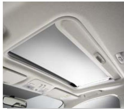
Люк крыши с электроприводом<sup>2</sup>
